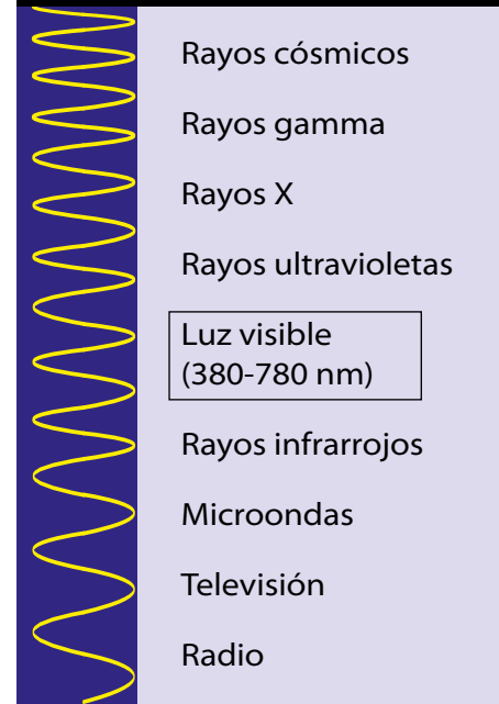
FIGURA 3. ESPECTRO DE ONDAS ELECTROMAGNÉTICAS
